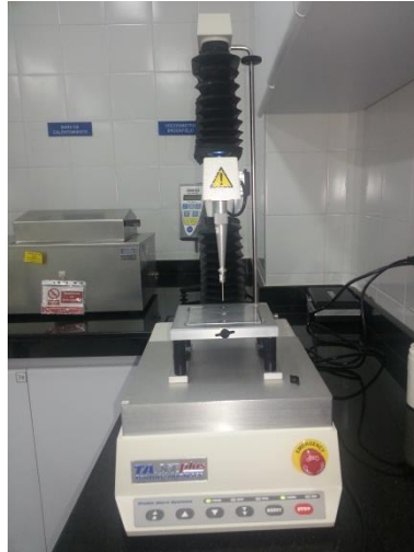
Figura 7. Ensayo de ruptura por penetración en instrumento TA XT plus Texture Analyser
